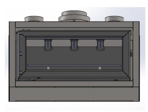
6. SLIDE THE BAFFLE PLATES ATOP THE OTHER 2 BAFFLE PLATES INTO THE MIDDLE POSITION AS SHOWN. LEAVE GAP OF 1-2 MM IN BETWEEN PLATES. THE GAPS SHOULD BE ROUGHLY IN THE MIDDLE OF THE AIR TUBES. UNIT IS NOW READY FOR USE.
