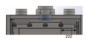
4. BAFFLE PLATE SIDE OF 222 MM SHOULD EXTEND FROM SIDE TO SIDE,
